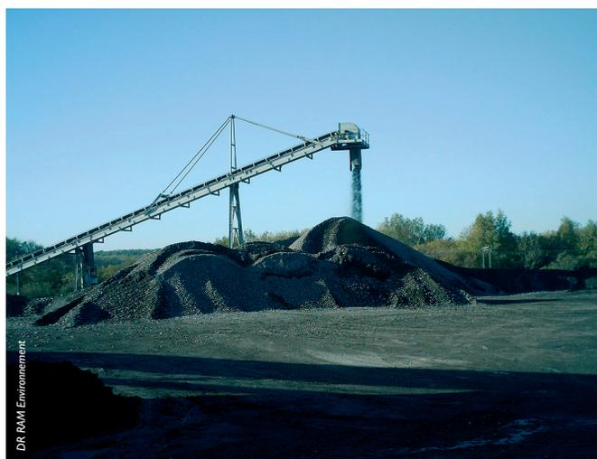
De manière générale, les poussières minérales étant neutres et n'imposant pas d'installations anti-explosion, les normes ATEX ne s'appliquent pas dans les carrières au niveau des équipements de production, excepté dans certaines mines où l'on extrait des produits explosifs ou inflammables tels que le soufre ou le charbon.
