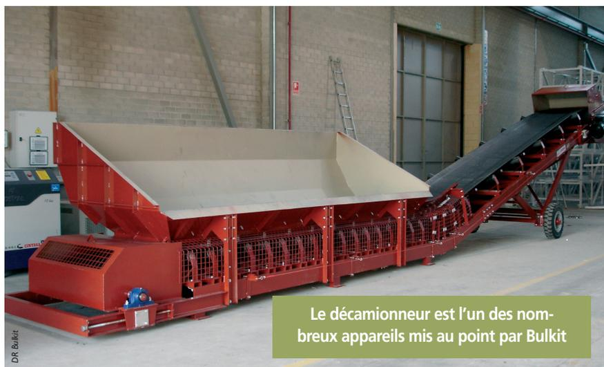
Le décarnionneur est l'un des nombreux appareils mis au point par Bulkit
