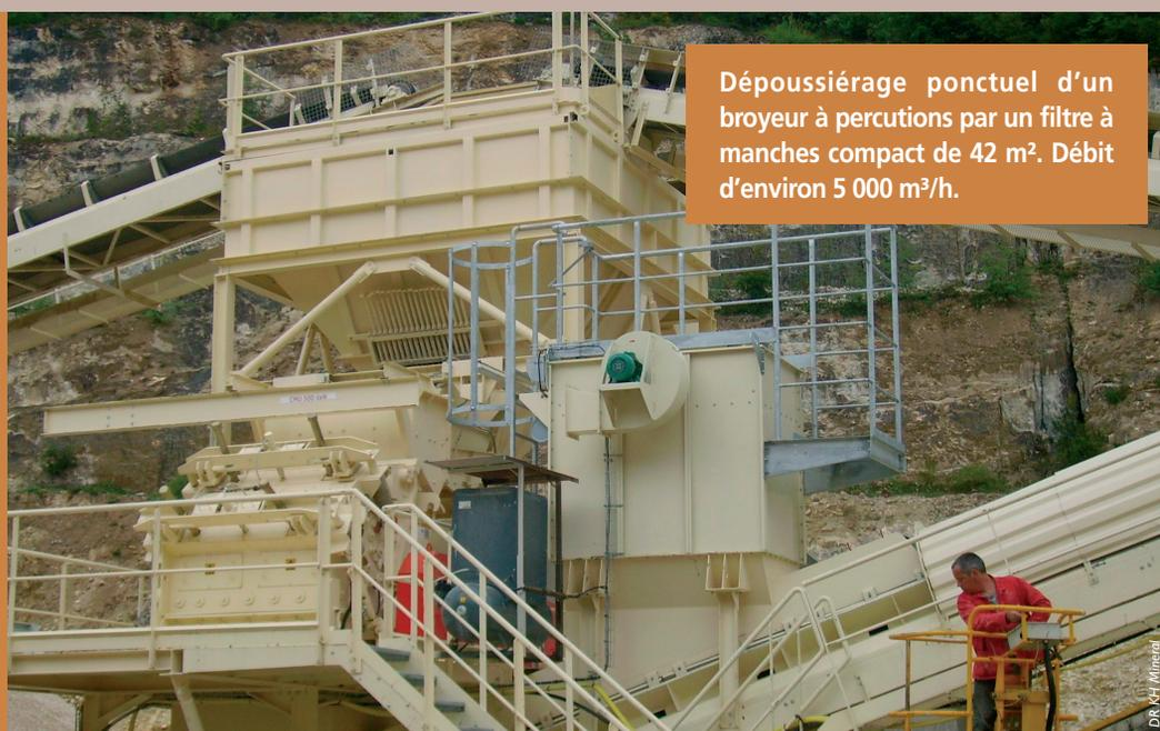
Dépoussiérage ponctuel d'un broyeur à percussions par un filtre à manches compact de 42 m<sup>2</sup>. Débit d'environ 5 000 m<sup>3</sup>/h.
