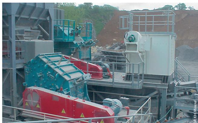
Dépoussiérage ponctuel d'un concasseur à percussions par un filtre à manches compact de 108 m<sup>2</sup>. Débit d'environ 12 000 m<sup>3</sup>/h.
