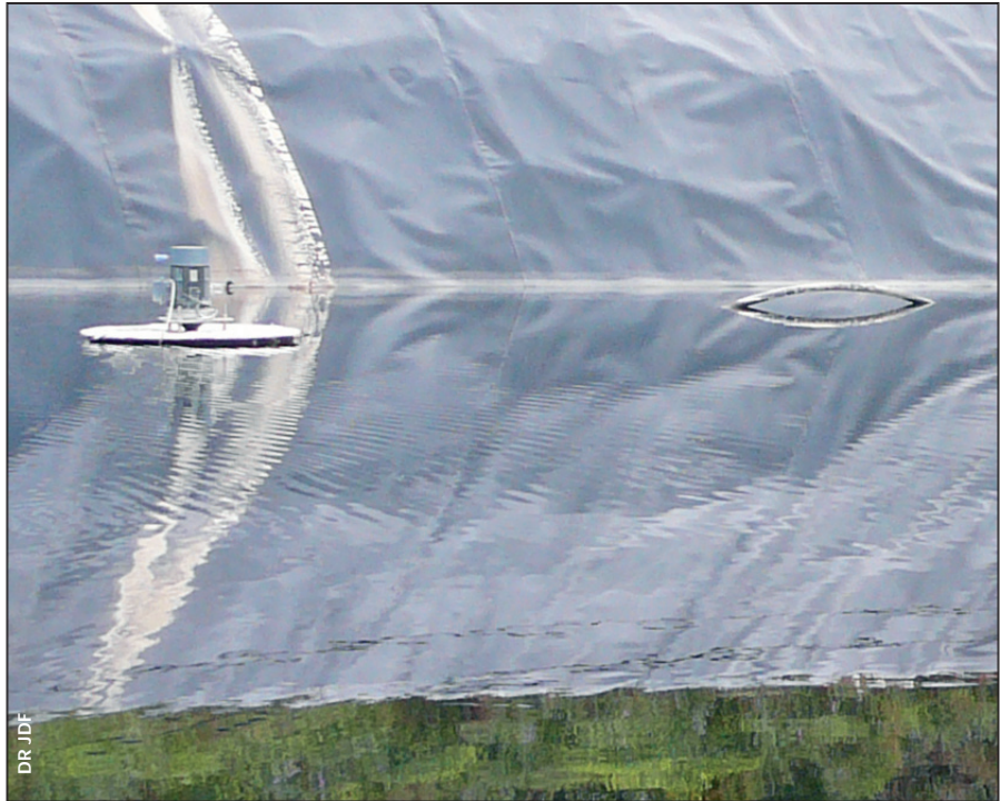
Le BGVAP : un appareil destiné au traitement thermique du lixiviat.
