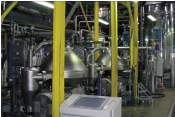
Centrifugeuses pour la neutralisation des huiles lors du processus de raffinage.
